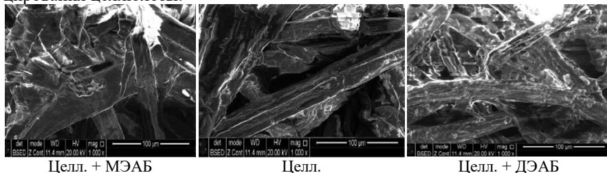
Рис. 8. Микроструктура ( \times 1000 ) целлюлозы до и после модифицирования (РЭМ)
